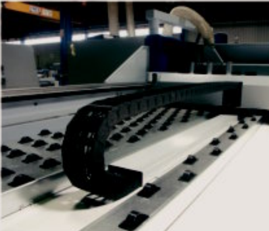
Chainflex® CF130.UL, numa máquina de moagem. Carga articulada 50kg/m.
